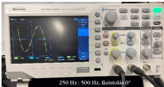
1. ábra. Lissajous-görbék oszcilloszkóp képernyőjéről fényképezve a különböző x - y csatornára tett frekvenciaarányok és fázistolások függvényében. A mutatott görbék természetesen számítógéppel is szimulálhatók, azonban érdekesebb az oszcilloszkóp képernyőjén látható jelalakokat közvetlenül fényképezni.
