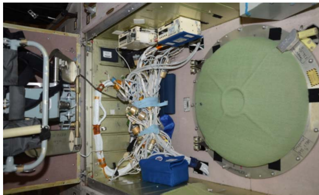
2. ábra. A kép tetején balra a régebbi, 2003-as és jobbra a 2018 júniusában felvitt új kiolvasó az Nemzetközi Űrállomáson.
