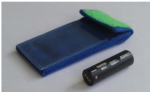
6. ábra. Az új típusú Pille dózismérő (lent) és a fényzárást és védelmet biztosító Nomex tároló tasak.
