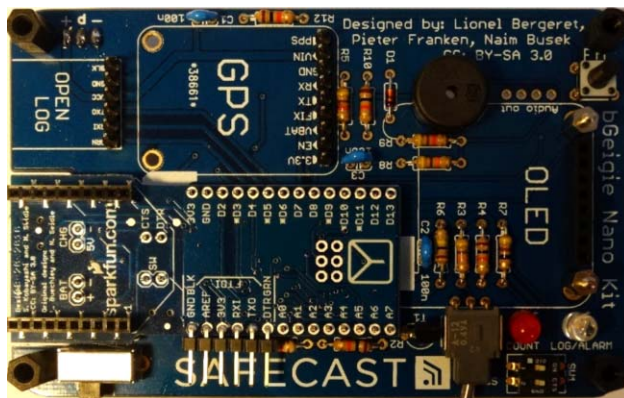
4. ábra. A főegységek helye beültetés előtt, az ellenállások, kondenzátorok, LED-ek, kapcsolók stb. már beforrasztásra kerültek.
