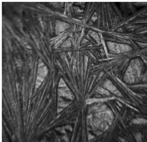
4. ábra. Ólomjodid alapú perovszkit nanodrótok szén nanocső hordozón. Optikai mikroszkópos felvétel.
