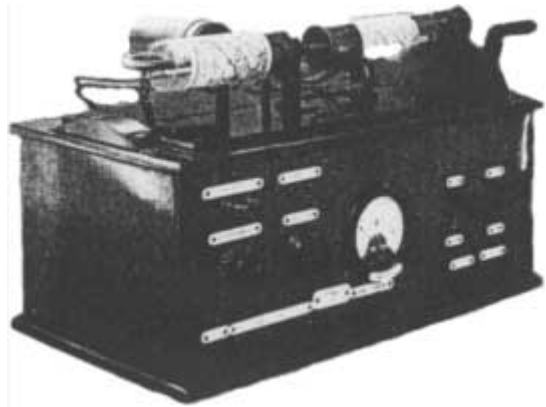
4. ábra. Selényi elektrostatikus képmásoló készüléke [5].
