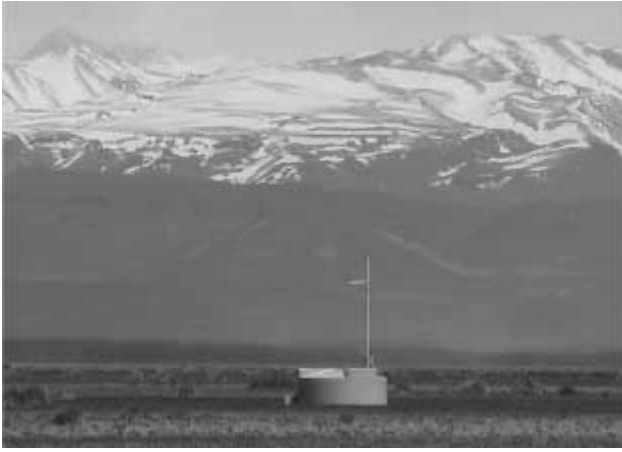
2. ábra. A Pierre Auger Koszmikus Sugárzási Observatórium egyik víz alapú Cserenkov-tankja, az argentinai Andok hegyvonulat lábánál. A 3000 km 2 műszerezett felületen elhelyezett 1600 tankból már 800, a 24 atmoszférikus fluoreszcens távcsőből már 12 működik.
