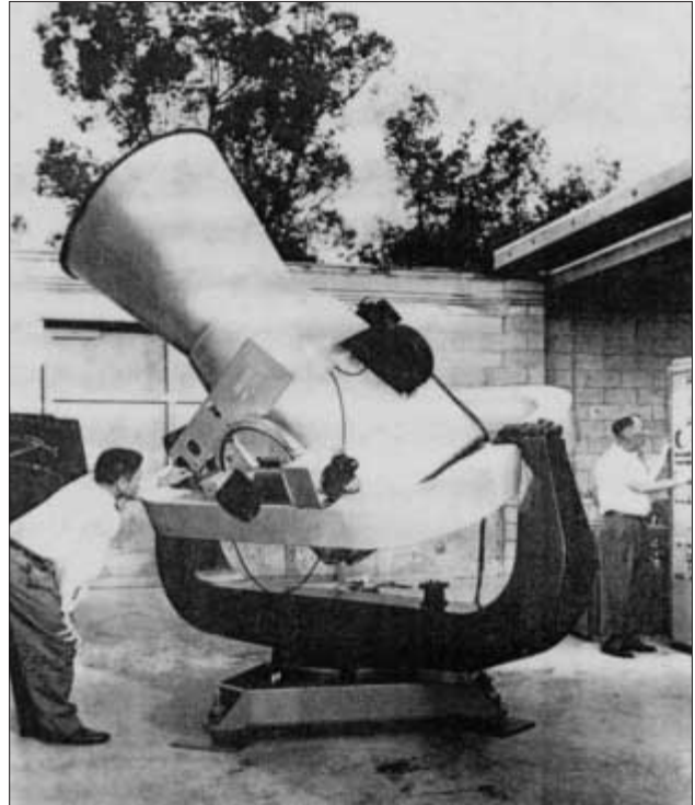
3. ábra. A Baker–Nunn műholdkövető kamerák Izsák Imre munkahelyén a Smithsonian Astrophysical Observatoryban ([1]-ből).
